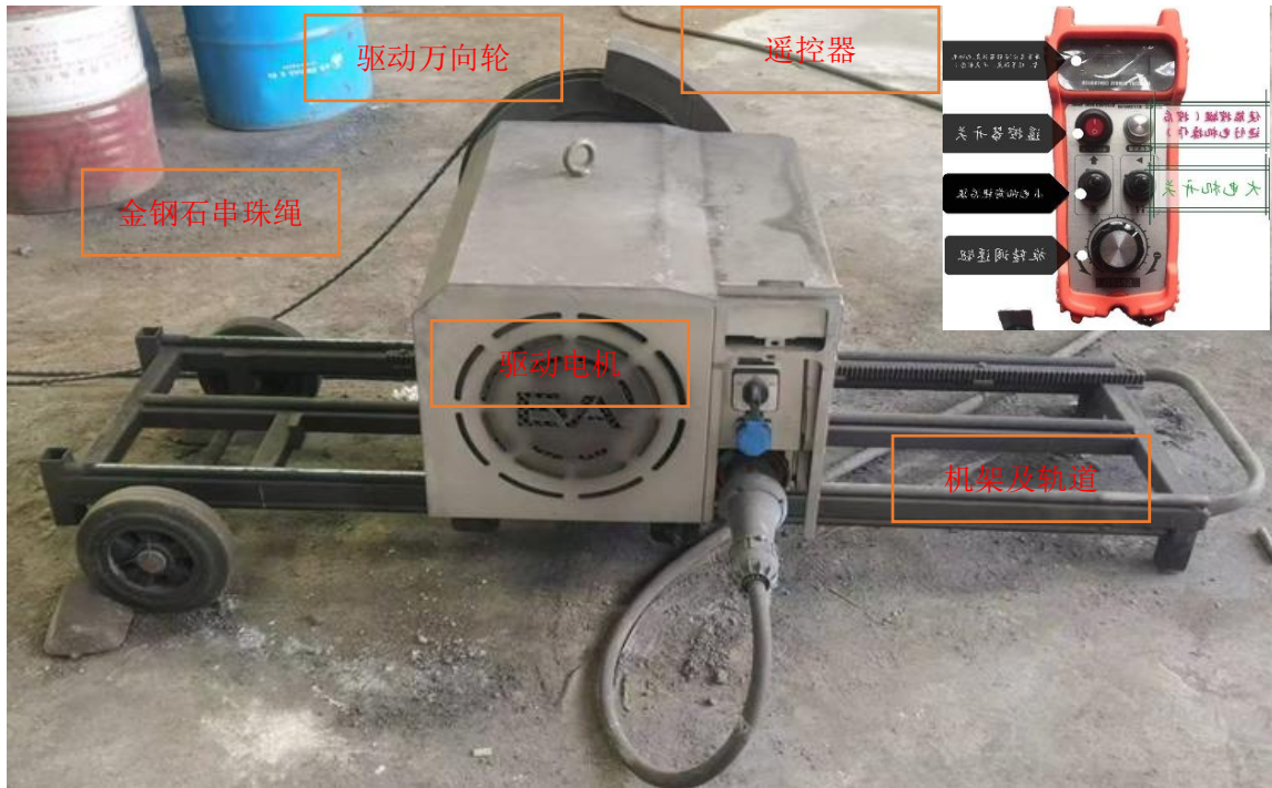
图 5 电动绳锯机结构图
