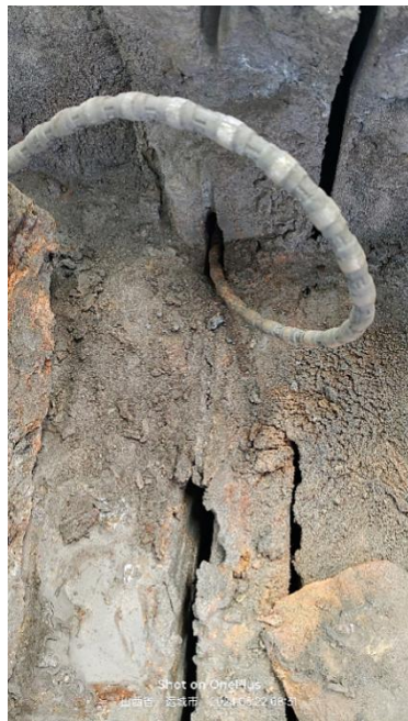
图 15 大块冰镍合金绳槽内卡阻物料（切割灰凝固）
