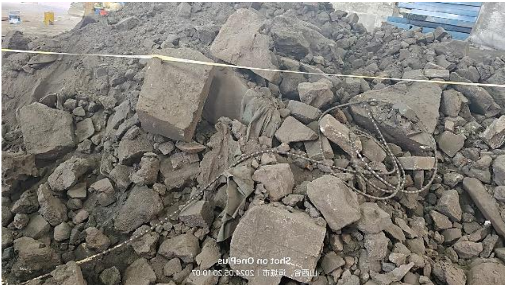
图 6 切割小块冰镍合金照片
