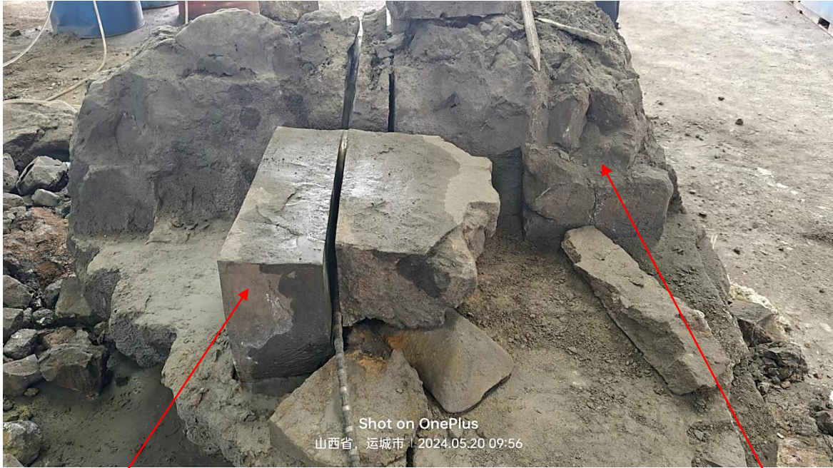
图 6 切割小块冰镍合金照片
