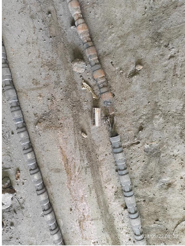
图 14 还原后的金刚石串珠绳接头连接情况（接头与一个金刚石串珠遗失）
