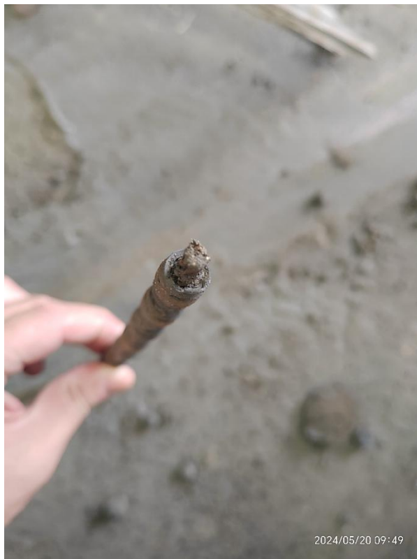
图 9 断裂的金刚石串珠绳端面（电动绳锯机万向轮下部）
