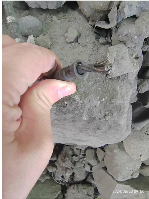
图 10 断裂的金刚石串珠绳端面（电动绳锯机万向轮上部）
