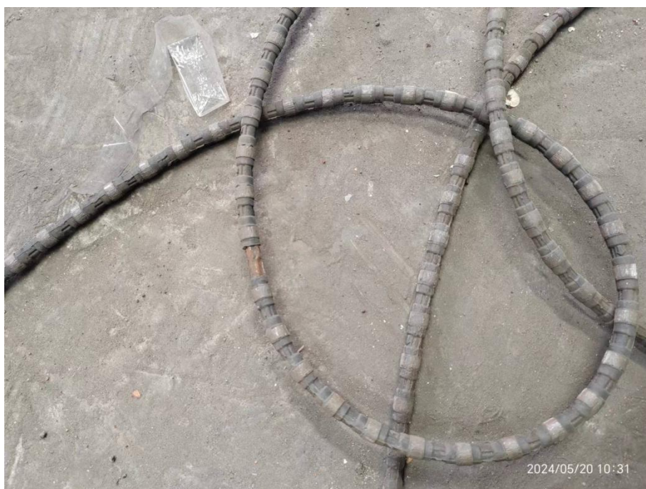
图 12 金刚石串珠绳接头连接效果图（同类型对比）
